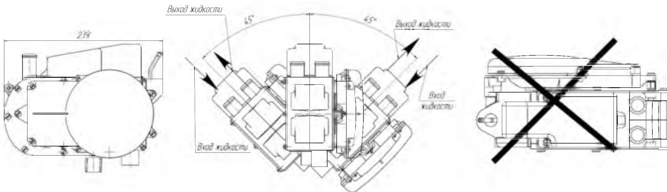
Рис. 7.2- Допустимые рабочие положения нагревателя
