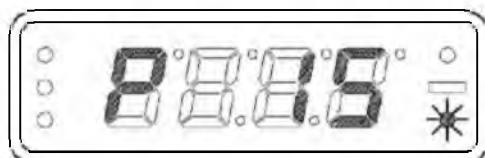
Figure 6.13 heater in «ignition mode»
