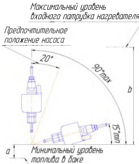
а - высота всасывания: до 500 мм при безнапорном баке;
