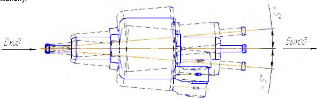
Рис. 7.8 Допустимое монтажное положение бензинового топливного насоса
