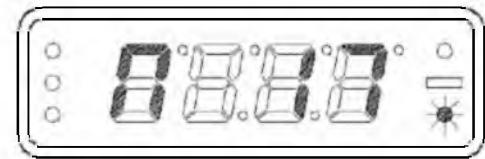
Рис 6.17 – Индикация в режиме продувки.
