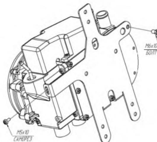
Рис. 7.1а – Схема крепления кронштейна.
