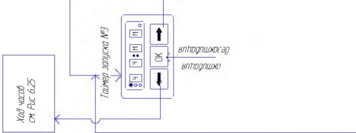
Рис. 6.27 – Схема работы с пультом при установке таймера для автоматического запуска подогревателя.
