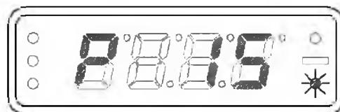
Рис. 6.13 – Индикатор при работе подогревателя в режиме розжига.
