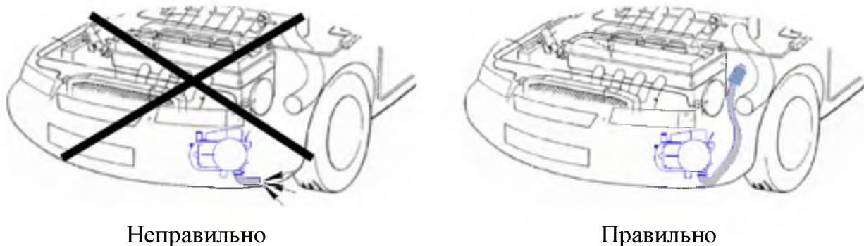
Рис.7.3а – Монтаж подогревателя за бампером.
